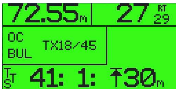
Figura 34: Schermata principale in immersione Circuito Aperto – Gas: Trimix 18/45 Sosta di Decompressione a 30 m per 1 minuto Tempo necessario all'emersione 41 minuti
