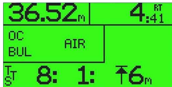
Figura 31: Schermata principale in immersione - Circuito Aperto - Gas: Aria Sosta di Decompressione a 6 metri per 1min Tempo necessario all'emersione 8 minuti
