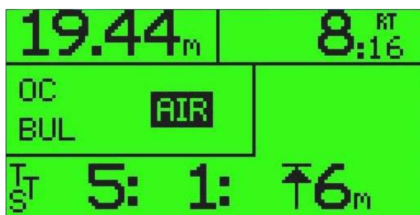
Figura 32: Schermata principale in immersione Circuito Aperto – Gas: Aria Sosta di Decompressione a 6 m per 1 minuto Tempo necessario all'emersione 5 minuti Avviso Cambio Miscela
