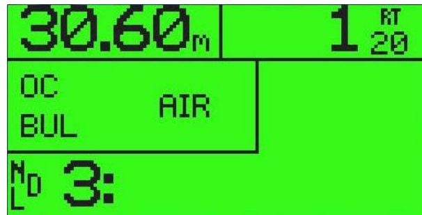
Figura 29: Schermata principale in immersione Circuito Aperto - Gas: Aria Tempo di Non Decompressione 3 minuti
