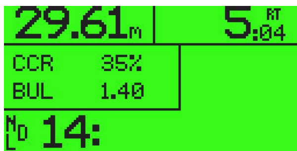
Figura 6: Schermata principale in modalità CCR (con sensor board abilitata)
