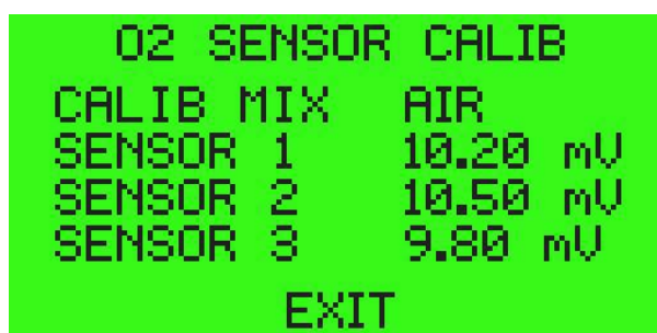
Figura 7: Schermata di Calibrazione (calibrazione in: ARIA)
