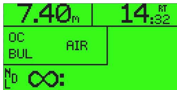
Figura 30: Schermata principale in immersione Circuito Aperto - Gas: Aria Tempo di Non Decompressione "illimitato"
