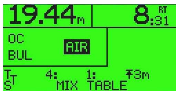
Figura 36: Schermata principale in immersione Avviso Cambio Miscela Menu per cambio Miscela
